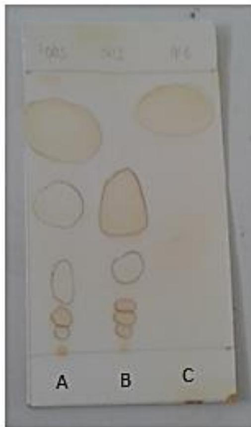
**Gambar 1.** Hasil penampakan noda Kromatografi Lapis Tipis (a) noda sampel biodiesel, (b) noda minyak kelapa sawit, dan (c) noda metil ester asam lemak.
