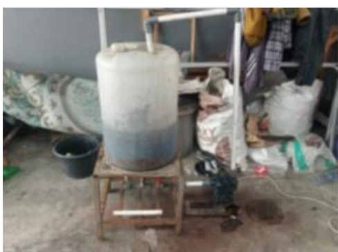
Gambar 7. Rangkaian alat proses uji korosi
