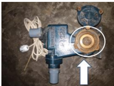
Gambar 8. Bagian pompa yang dilindungi inhibitor
