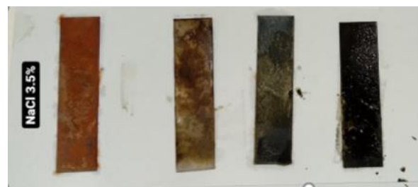
Gambar 5. Penampakan baja hasil uji korosi
