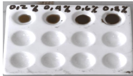
Gambar 1 Hasil uji kualitatif senyawa tanin dengan larutan \text{FeCl}_3
