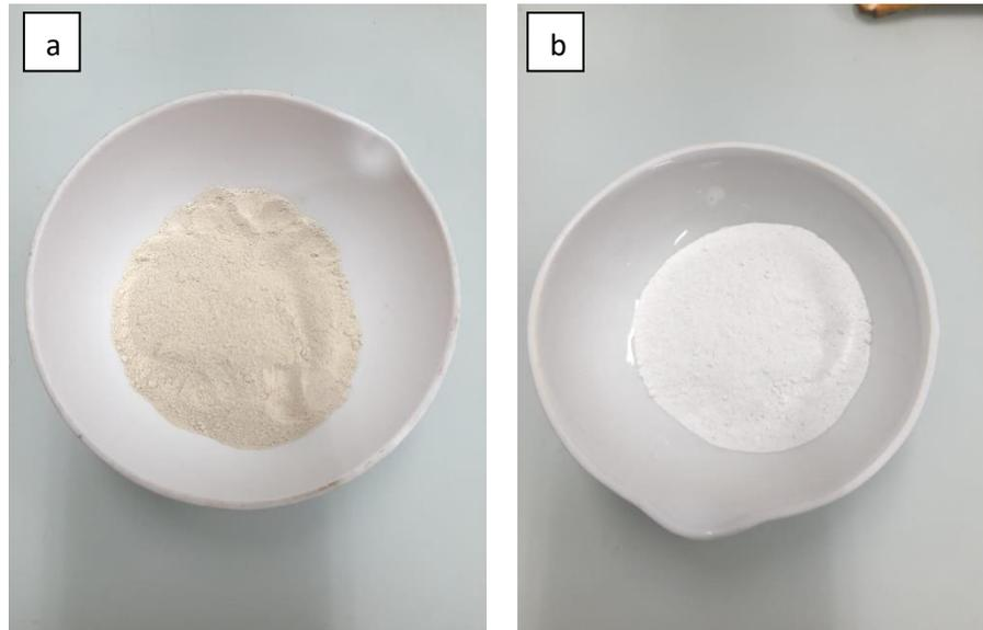
**Gambar 2.** (a) Limbah padat geothermal sebelum dan (b) setelah proses *acid leaching*
